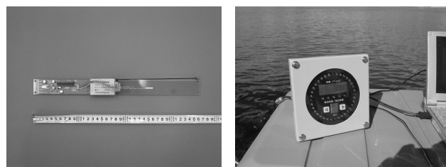
写真 1 開発した GPS ブイの基板 (左) と受信端末 (右)
